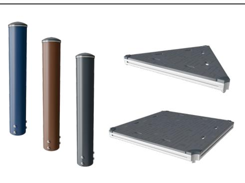
立柱由优质预镀锌钢制成，表面覆盖粉末涂层。柱顶由防紫外线的尼龙 (PA6) 盖封闭。灰色模压平台底板由 75% 海洋渔业消费后可循环 PP 材料制成，表面有防滑图案和纹理。所有平台底板均由独特设计的低碳铝型材支撑，可安装多种不同游戏板功能配件。
