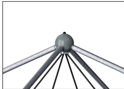
Jedinečně navržené spojovací koule o průměru 230 mm jsou vyrobeny z vysoce kvalitního hliníku s povrchovou úpravou práškovou barvou. Vnitřní napínací části jsou vyrobeny z žárově pozinkované oceli.
