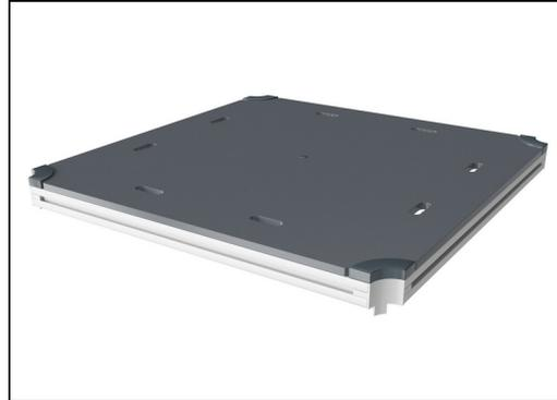
Alle Bodenplatten werden von einzigartig gestalteten kohlenstoffarm gefertigten Aluminiumprofilen und mehreren Befestigungen getragen. Die grau gefärbten, spritzgussgeformten Bodenplatten bestehen zu 75 % aus recycelten Fischernetzen (PP-Material) und haben ein rutschfestes Muster und eine strukturierte Oberfläche.
