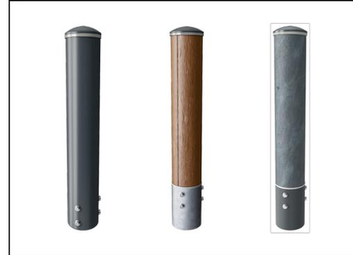
Hauptpfosten mit Fuß aus feuerverzinktem Stahl sind in verschiedenen Materialien erhältlich: Pfosten aus kesseldruckimprägniertem Kiefernholz. Innen und außen bandverzinkter Stahl mit pulverbeschichteter Oberfläche. Bleifreies Aluminium mit farbig eloxierter Oberfläche. Greenline TexMade Pfosten aus 100% recyceltem PE und Textilabfällen.
