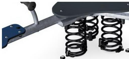
Los muelles KOMPAN están hechos de acero de resorte de alta calidad según EN10270. Los muelles se limpian mediante fosfatación antes de pintarlos con una imprimación epoxi y un recubrimiento de poliéster en polvo como acabado superior. Los muelles se fijan mediante accesorios anti-pellizcos únicos para máxima seguridad y larga vida útil.
