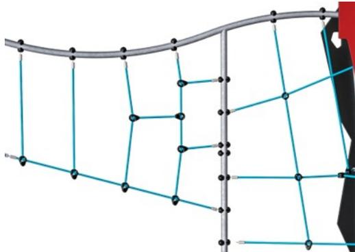
Die Seile sind aus UV-stabilisierten PP-Seilsträngen mit innerer Stahlseilverstärkung gefertigt. Die horizontalen Seile sind PUR-beschichtet, um eine gute Verschleissfestigkeit zu erreichen.
