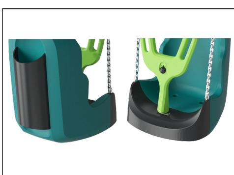
Den främre stötfångaren är tillverkad av en kärna av stark polypropylen (PP) med ett mjukare yttre lager av termoplastiskt gummi (TPE) och den bakre stötfångaren av 8 mm tjockt EPDM-membran. De mjuka, stötdämpande stötfångarna med halkfri yta gör gungsitsen extremt säker att använda för vårdnadshavare.
