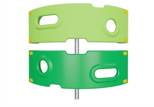
所展示的攀爬部件为一体成型的，壁厚 5 毫米（最低厚度），由可循环的聚乙烯材料制成，抗冲击性强，适用温度范围广，在任何位置都能抵抗破坏。
