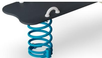
Les ressorts KOMPAN sont fabriqués en acier de haute qualité selon la norme EN 10270. Les ressorts sont nettoyés par phosphatation, avant d'être peints avec une amorce époxy et un revêtement thermolaqué de polyester en guise de finition. Les ressorts sont fixés par des raccords anti-pincement uniques pour une sécurité maximale et une longue durée de vie.
