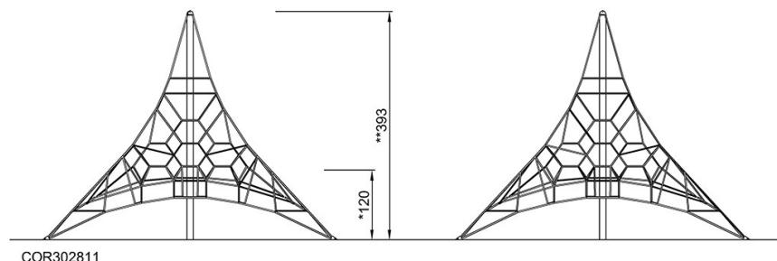
Pozor! Základové kotevní bloky překračují oblast bezpečnostní zóny. Viz pokyny k instalaci
