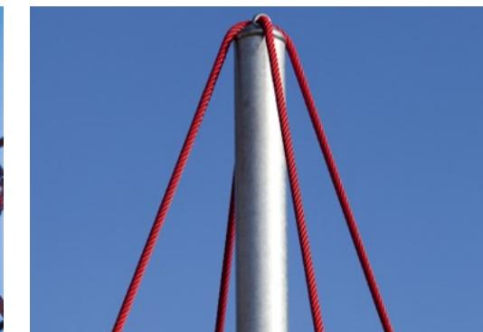
Střed síťě je podepřen stožárem, vyrobeným z vysoko kvalitní bezešvé oceli. Konstrukce stožáru jako volné podpěry je staticky výhodná a vyrovňává oscilaci celé sítě. Stožáry jsou standardně pozinkovány v horké lázni a na přání mohou být povrchově upraveny práškovou barvou.
