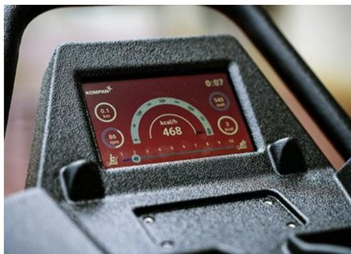
Lo schermo LCD da 7 pollici con vetro di protezione IK8 fornisce un feedback immediato su velocità, distanza, tempo, calorie bruciate ecc. La resistenza del crosstrainer può essere regolata sullo schermo.
