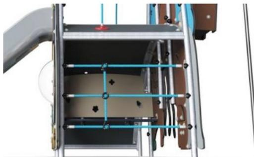
Les filets d'escalade sont fabriqués en corde PA avec stabilisation UV et renforcement intérieur par câblage en acier. La corde est traitée par induction afin d'obtenir une fixation optimale entre l'acier et la corde, offrant ainsi une excellente résistance à l'usure. Tous les connecteurs de corde sont fabriqués en matériaux PA 100 % recyclables.
