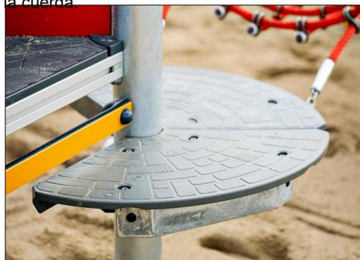
Todas las cubiertas están respaldadas por una construcción de acero única con múltiples soportes y fijaciones. Las plataformas HPL con un grosor de 17.8 mm tienen una resistencia al desgaste muy alta y presentan una textura de superficie antideslizante KOMPAN única.
