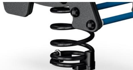
Les ressorts KOMPAN sont fabriqués en acier de haute qualité selon la norme EN 10270. Les ressorts sont nettoyés par phosphatation, avant d'être peints avec une amorce époxy et un revêtement thermolaqué de polyester en guise de finition. Les ressorts sont fixés par des raccords anti-pincement uniques pour une sécurité maximale et une longue durée de vie.
