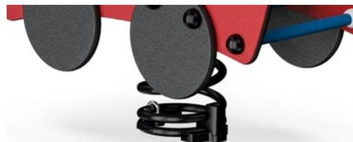
Le molle KOMPAN sono realizzate con acciaio per molle di alta qualità secondo EN10270. Le molle vengono pulite mediante fosfatazione prima di essere verniciate con un primer epossidico e un rivestimento in polvere di poliestere come finitura superiore. Le molle sono fissate da esclusivi raccordi anti pizzico per la massima sicurezza e lunga durata.
