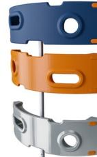
所展示的攀爬部件为一体成型的，壁厚 5 毫米（最低厚度），由可循环的聚乙烯材料制成，抗冲击性强，适用温度范围广，在任何位置都能抵抗破坏。
