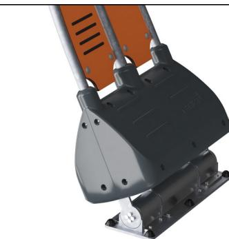
来回摇摆运动由重型比例的双橡胶扭转弹簧元件控制。橡胶元件可确保安全运动并降低朝向塔台平台的速度。模压 PE 材料的底盖具有高抗冲击性。
