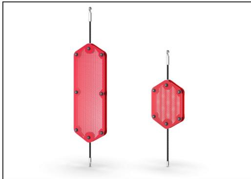
Otočné optické panely ze dvou 7mm silných polykarbonátových desek se vzdáleností 40mm. Vnitřní grafický potisk se skládá z vnitřní obrazové vrstvy a vnější průhledné ochranné vrstvy. PC panel i lak na vodní bázi jsou UV stabilizované, aby se zabránilo vyblednutí tisku.
