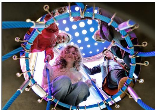
Lana Corocord vyrobena z UV stabilizovaných PES lanových pramenů s vnitřní výztuží z ocelových lan. Polyesterová příze je z více než 95 % tvořena post-spotřebními materiály a je indukčně natavena na každé vlákno. PES je velmi pevný a oplívá vynikající odolností proti oděru a UV záření. Lana jsou spojena nerezovými S-svorkami, které jsou nalisovány kolem lana, což má za následek odolné řešení.
