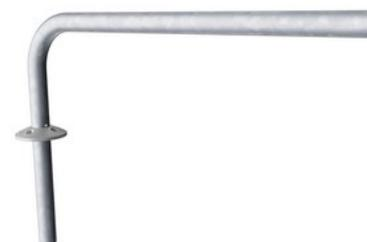
I corrimani intesi come impugnature durante gli esercizi sono realizzati in acciaio zincato a caldo da 38 mm, un grande diametro per una buona presa e per sostenere il polso. L'altezza del corrimano è 940 mm dalla parte superiore della piastra HPL. La distanza tra le rotaie è di 900 mm.
