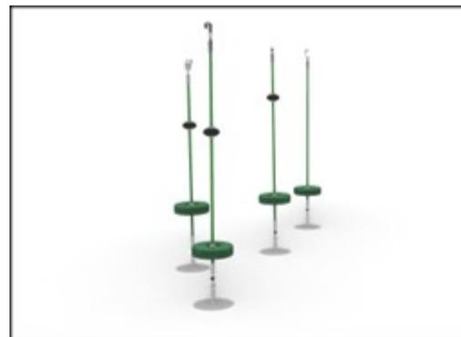
Les disques sont entièrement en caoutchouc EPDM, colorés et lissés. L'EPDM est moulé autour d'une bague en acier galvanisé à chaud qui assure à la fois la stabilité des disques et une fixation durable sur la corde.
