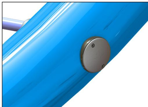
La corde est fixée au grand tube en acier par une solution de serrage unique conçue par KOMPAN. Il se compose de bagues intérieures et extérieures en nylon (PA6) qui guident la corde vers une partie extérieure fileté en acier inoxydable qui serre la corde.
