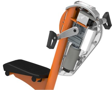
创新的自供电电机和齿轮提供了一个虚拟变速箱，提供真正的骑行体验。阻力为自动驱动，自动适应踏板速度。用户可以通过应用程序手动调节电阻 (26 瓦)。
