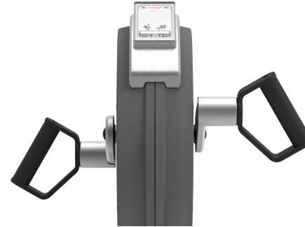
自行车的 Q 系数为 175mm，曲柄为 18mm 不锈钢制成，连接踏板臂为铸不锈钢 (304 级) 件。踏板臂长 170 毫米，踏板与标准自行车配件连接。
