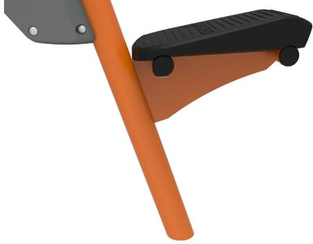
该座椅由聚氨酯橡胶制成，并由钢嵌板将它连接到钢架上。座位呈 12 度角，座位高度可在 550 - 620mm 范围内调节。
