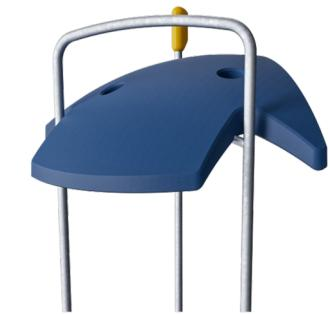
ELEMENTS 屋顶由可回收的 PE 制成，最小壁厚为 5 mm，以确保在全球所有气候条件下都具有较高的耐用性。钢管在内部和外部均热浸镀锌，以实现最大的耐用性。
