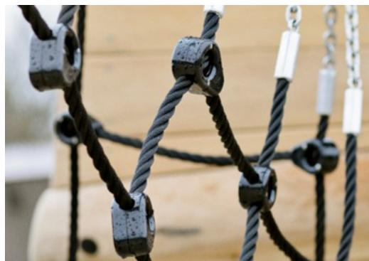
Sítě a lana jsou vyrobeny z PA stabilizovaného proti UV záření s vnitřní ocelovou výztuží. Lano je indukčně ošetřeno, aby se vytvořilo silné spojení mezi ocelí a lanem, což vede k dobré odolnosti proti opotřebení.
