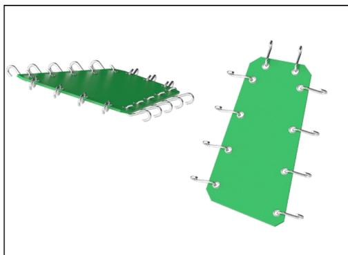
Die Corocord Membranen bestehen aus rutschfestem, gummiertem Material in Förderband-Qualität, das eine exzellente UV-Beständigkeit aufweist. Die geprüfte Konformität mit den REACH-Anforderungen für PAK ist gegeben. In die Membranen ist eine vierlagige Armierung aus gewebtem Polyester eingebettet. Die Armierung und die doppelte Oberflächenschicht ergeben eine Gesamtstärke von 8 mm.
