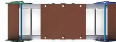
Les sièges et la plate-forme sont faits de contreplaqué de 22 mm d'épaisseur en bois d'aulne et de pin. Les deux côtés sont revêtus de 2 couches de film phénolique avec texture de filet anti-dérapante. Tout les bords de coupe sont enfermés avec de la peinture afin d'assurer une longue durée de vie.
