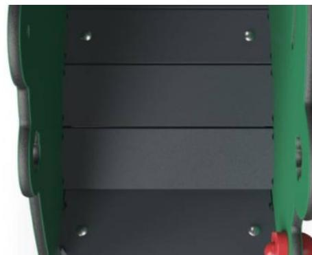
Gli steps sono realizzati in HPL con uno spessore di 17,8 mm con una resistenza all'usura molto elevata e un'esclusiva struttura superficiale antiscivolo KOMPAN.
