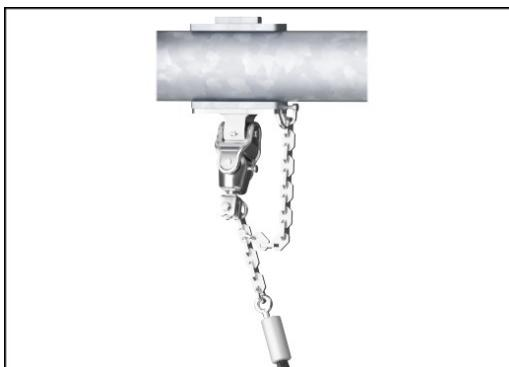
Odolné houpačkové závěsy KOMPAN z nerezové oceli s anti-twist funkcí. Závěsy jsou připevněny k příčnému nosníku na svařované konzole se dvěma šrouby. Ložiska jsou zabudována se silikonovým mazivem a nepotřebují další mazání.
