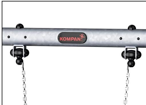
Houpací závěsy jsou vyrobeny z vysoce kvalitního nylonového (PA6) pouzdra stabilizovaného proti UV záření s integrovanými kuličkovými ložisky, utěsněnými po celou dobu životnosti. Výškově nastavitelné řetězy jsou připevněny hákem z nerezové oceli s bezpečnostními šrouby se dvěma otvory v otočném pouzdru s funkcí anti-twist proti zkroucení. Všechny sedáky se dvěma řetězy sou k dispozici se standardním nebo anti-twistem.
