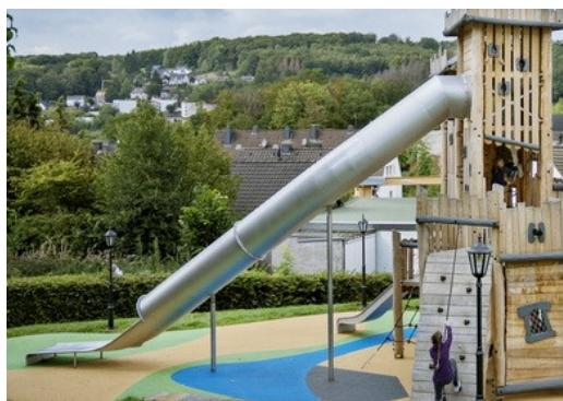
Zakřivené a rovné tunelové skluzavky z nerezové oceli jsou podepřeny několika ocelovými tyčemi na středový ocelový sloupek. Tunelové skluzavky jsou navrženy s dokonalou křivkou a sklonem pro hravou jízdu.
