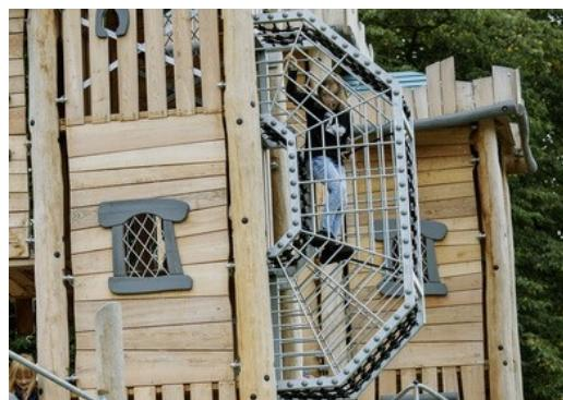
Tunel z drátěného rámu je vyroben z vysoko kvalitní, žárově zinkované oceli. 16mm lana Corocord jsou speciální typ "Hercules" s pozinkovanými, čtyřvláknovými, ocelovými dráty a jádrem z ocelového drátu. Každý pramen je pevně zabalen přízi PES, která se roztaží na každém jednotlivém prameni.
