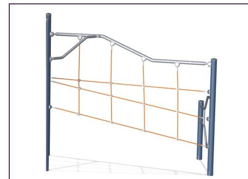
ELEMENTS 绳索具有六股钢丝和钢丝芯。每根丝束都用 PES 纱紧密包裹，然后将其熔化到每根单独的丝束上。在最初的摩擦力去除了表面纤维之后，保留了较硬的 PES 涂层以保护每根股绳，从而使绳索具有极高的耐磨性和防破坏性。
