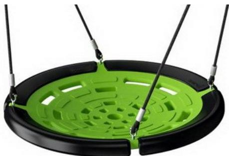
La scocca è realizzata in polietilene (PE) riciclabile al 100% e stampata in rotazionale in un unico pezzo. Il sedile è progettato con grandi aperture esterne per le maniglie e fori centrali per il drenaggio di acqua e sporco. Le quattro funi sono fissate con staffe in acciaio zincato a caldo per garantire una lunga durata.
