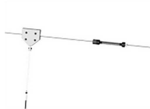
Das hochwertige Stahlseil mit einem Durchmesser von 12 mm wurde für eine dauerhafte starke Benutzung der Seilbahn konzipiert. Der Ausgangspunkt ist durch einen Knopf gekennzeichnet. Am Haltepunkt befindet sich eine speziell entwickelte Federvorrichtung, welche ein sanfteres Stoppen der Zugvorrichtung gewährleistet.
