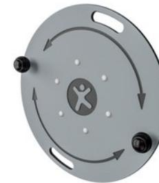
Das Rad mit ø800x19mm ist aus einer HDPE EcoCore™-Platte gefertigt. EcoCore™ ist ein äußerst haltbares, umweltfreundliches Material, dass nicht nur recycelt werden kann, sondern auch einen Kern aus 100 % Recyclingmaterial enthält. Der Kern hat eine Dicke von 15 mm und macht 80% des Gesamtmaterials aus.
