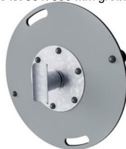
Das Lagergehäuse ist aus feuerverzinktem Stahl gefertigt. Die Lagerwelle ist aus rostfreiem Stahl AISI304 gefertigt. Das Lager selbst besteht aus Polyoxymethylen (POM), einem technischen Thermoplast mit hoher Steifigkeit, geringer Reibung und ausgezeichneter Formbeständigkeit.
