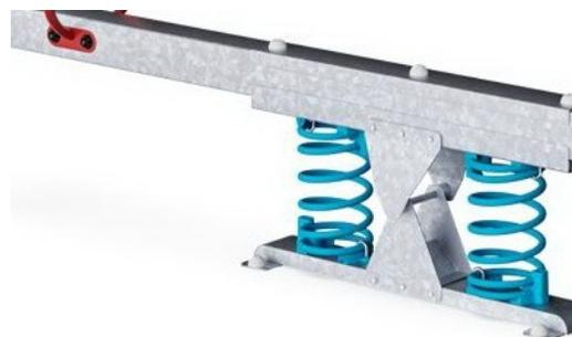
Le molle KOMPAN sono realizzate con acciaio per molle di alta qualità secondo EN10270. Le molle vengono pulite mediante fosfatazione prima di essere verniciate con un primer epossidico e un rivestimento in polvere di poliestere come finitura superiore. Le molle sono fissate da esclusivi raccordi anti pizzico per la massima sicurezza e lunga durata.
