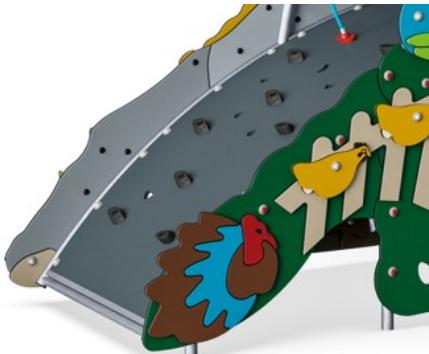
Zakřivená lezecká stěna je vyrobena z panelu Ekogrip®, který se skládá z 15 mm silné PE základny s 3 mm horní vrstvou měkké pryže s protiskluzovým efektem.
