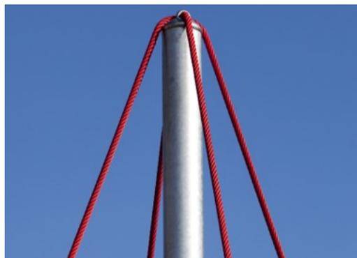
Al centro della rete si trova l'albero, realizzato in acciaio senza saldatura di alta qualità. La struttura dell'albero come supporto oscillante è staticamente favorevole ed equalizza le oscillazioni nella rete. Gli alberi sono zincati a caldo, con l'opzione di progettazione di verniciatura a polvere aggiuntiva.
