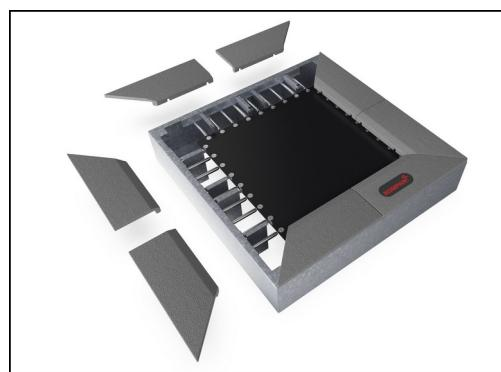
Jedinečnou vlastností je, že dlaždice SBR lze kvůli čištění a servisu vyjmout. Povolením šesti šroubů lze dlaždici SBR zvednutím otevřít a získat přístup k pružinám (viz návod na KOMPAN Master).
