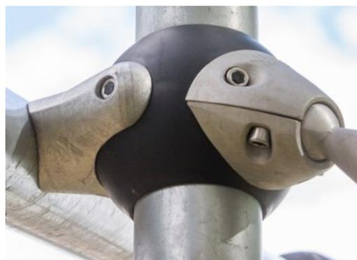
Die speziell entwickelte Galaxy Verbindungskugel besteht aus einem runden Aluminiumkern, der von einer mit TPV gummierten Kunststoff-Schale (PP) umgeben ist. Die beweglichen Verbindungselemente aus bleifreiem Aluminium ermöglichen eine flexible Montage.
