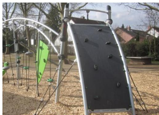
Die gewölbte Kletterwand ist aus einer im Stahlrahmen eingelassenen EcoGrip® Platte gefertigt und verfügt über speziell gefertigte Kletterstollen. Die EcoGrip® Kletterwand besteht aus Polyethylen mit einer Plattendicke von 15 mm und einer 3 mm starken TPE-Oberflächenbeschichtung, die für einen Anti-Rutsch Effekt sorgt.
