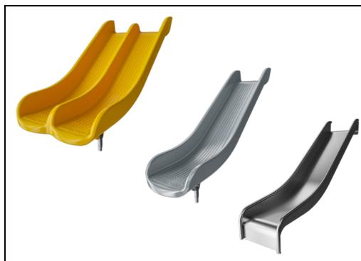
Skluzavky jsou k dispozici v lisovaném PE v různých barvách nebo v nerezové oceli AISI304 t = 2 mm.
