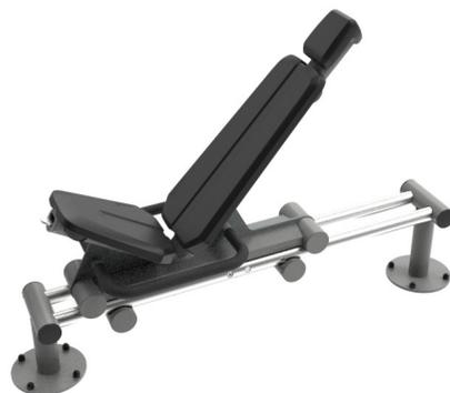
El asiento y el reposacabezas están hechos de caucho de poliuretano y tienen una placa de inserción de acero que los conecta al marco de acero. El asiento es ajustable en 14 posiciones diferentes para adaptarse a usuarios de 140/205 cm de altura y para variar el tipo de ejercicios. El asiento se coloca en un ángulo de 12 grados y el respaldo soporta un ángulo de 48 grados. El respaldo tiene una ranura que permite una posición cómoda.
