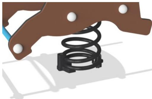
Los muelles KOMPAN están hechos de acero de resorte de alta calidad según EN10270. Los muelles se limpian mediante fosfatación antes de pintarlos con una imprimación epoxi y un recubrimiento de poliéster en polvo como acabado superior. Los muelles se fijan mediante accesorios anti-pellizcos únicos para máxima seguridad y larga vida útil.
