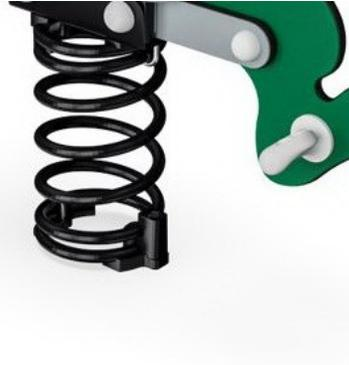
KOMPAN Federn bestehen aus hochwertigem Federstahl nach EN 10270-1. Die Federn werden durch Phosphatierung gereinigt, bevor sie mit einer Epoxid-Grundierung und Polyester-Beschichtung überzogen werden. Die Federn werden mit speziellen Klemmschutz-Elementen angebracht, um für höchste Sicherheit und eine hohe Lebensdauer zu sorgen.
