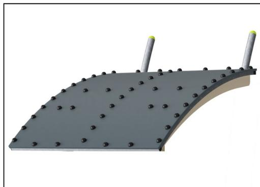
Il tetto è costituito da un pannello Ekogrip® supportato da telaio in acciaio. Il pannello Ekogrip® è costituito da una base in polietilene di 15 mm di spessore con uno strato superiore di gomma da 3 mm.
