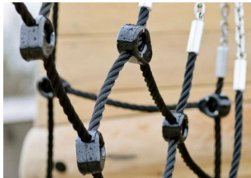
Lana jsou vyrobena z UV stabilizovaných PES pramenů lana s vnitřní výztuhou ocelovým lankem. Polyesterový obal je indukčně nataven na každý pramen, aby se získala vynikající odolnost proti opotřebení a roztržení.
