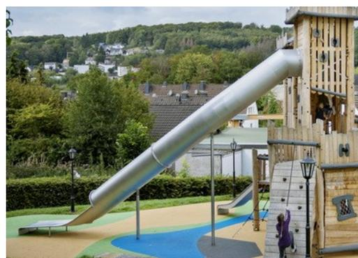
Les glissières de tunnel courbées et droites en acier inoxydable sont soutenues par plusieurs tiges en acier à un poteau central en acier. Les glissières du tunnel sont conçues avec une courbe et une inclinaison parfaites pour une conduite ludique.
