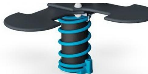
Les ressorts KOMPAN sont fabriqués en acier de haute qualité selon la norme EN 10270. Les ressorts sont nettoyés par phosphatation, avant d'être peints avec une amorce époxy et un revêtement thermolaqué de polyester en guise de finition. Les ressorts sont fixés par des raccords anti-pincement uniques pour une sécurité maximale et une longue durée de vie.
