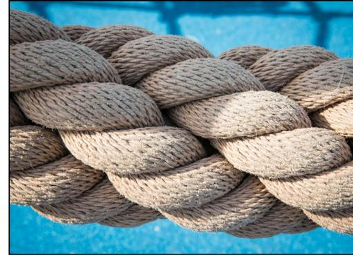
椰子风格的 PP 绳直径为 150 毫米。内部钢丝芯的两端都有针箍，将绳索固定到现有连接元件上。
