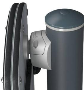
Los conectores están fabricados en aluminio fundido a presión especialmente aleado para entornos exteriores y con un contenido de plomo inferior a 100 ppm. Los conectores se fijan a los postes mediante tornillos de acero inoxidable y están bien protegidos contra la corrosión mediante arandelas de zinc de diseño especial. Son extremadamente resistentes y no presentan ningún riesgo de corrosión.
