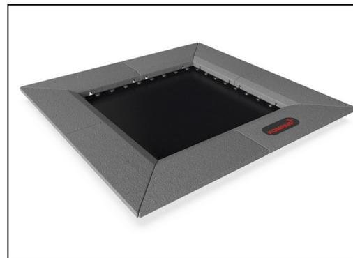
Les dalles sont moulées en caoutchouc recyclé granulé gris (SBR / NR), et le logo KOMPAN est en EPDM Ethylène Propylène Diène Monomère. À l'intérieur de chacune des tuiles en caoutchouc se trouve une plaque d'acier galvanisé à chaud de 3 mm.
