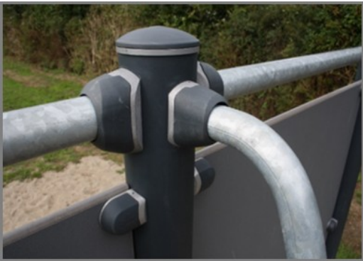
Die Verbinder sind aus druckgegossenem Aluminium hergestellt, das speziell für den Außenbereich und starke Beanspruchung legiert ist. Die Schrauben zur Befestigung der Verbinder sind aus Edelstahl und durch Zink-Unterlegscheiben geschützt.
