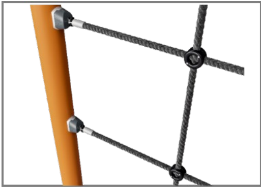
Die Seile bestehen aus UV-stabilisiertem PES mit innerer Stahlseilverstärkung. Das Seil ist induktionsbehandelt, um eine starke Verbindung zwischen Stahl und Seil zu schaffen, die zu einer guten Verschleißfestigkeit führt.
