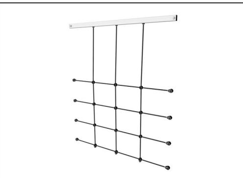
Lezecké sítě jsou vyrobeny z UV stabilizovaného PP lana s výztuží vnitřního ocelového kabelu. Lano je indukčně ošetřeno tak, aby se dosáhlo maximální fixace mezi ocelí a lanem, což zajišťuje vynikající odolnost proti opotřebení a roztržení. Všechny lanové konektory jsou vyrobeny ze 100% recyklovatelného PA materiálu.
