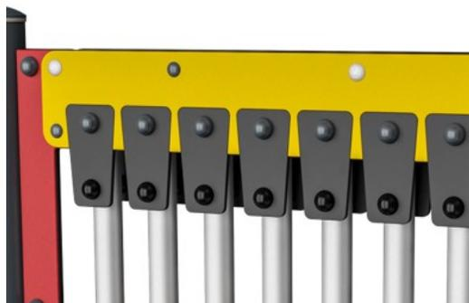
Les membranes sont constituées d'un matériau en caoutchouc aux propriétés résistantes aux frottements et aux UV. Quatre couches d'armature en polyester tissé sont intégrées. L'ensemble a une épaisseur totale de 9 mm.
